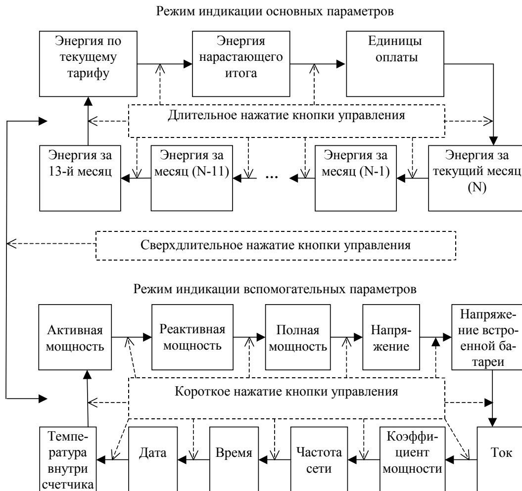
Рисунок Г.1 - Последовательность смены режимов индикации по кнопке управления
